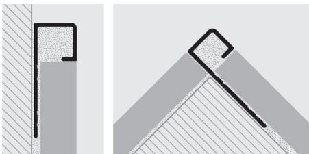
1. Choisir le PROJOLLY SQUARE d'une hauteur correspondant à l'épaisseur du support. 2. Appliquer la colle dans la partie adaptée du profil. 3. Poser et aligner le profil, déjà coupé à la longueur nécessaire, en appuyant l'ailette perforée sur la colle. 4. Poser les carreaux de façon que la partie supérieure du profil soit alignée. 5. Remplir complètement de colle la zone de contact entre le profil et le carreau pour éviter les infiltrations d'eau.
