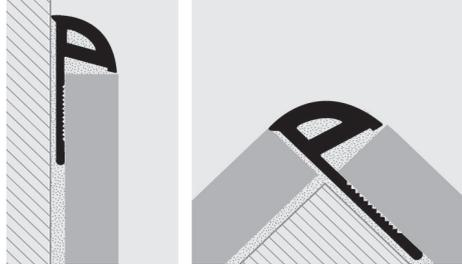
1. Je nach Höhe der Fliese und Farbe "PROJOLLY" auswählen. 2. Das zugeschnittene "PROJOLLY" anbringen, anpassen und Fliesenkleber in Anwendungsbereich auftragen. 3. Der Schenkel von "PROJOLLY" auf die Klebmasse drücken. 4. Die Fliesen sorgsam auf gleicher Höhe mit der Profilkante mit einer Fuge von etwa 2 mm anbringen. 5. Der Raum zwischen Profil und Fliesen großzügig mit Fugenkleber gegen Wassereinträge absichern.
