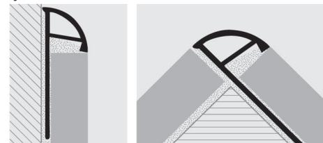
1. Elegir "PROJOLLY ECO MARBLE" en función de el espesor de la baldosa y de el acabado requerido. 2. Cortar "PROJOLLY ECO MARBLE" a la medida necesaria y aplicar el cemento cola al soporte donde se tendrá que colocar el perfil. 3. Presionar la aleta del perfil PROJOLLY ECO MARBLE en el cemento cola. 4. Colocar la baldosa alineando la misma al perfil y dejando una junta de 2 mm entre perfil y baldosa. 5. Rejuntar entre baldosa y perfil para evitar que se filtre el agua.
