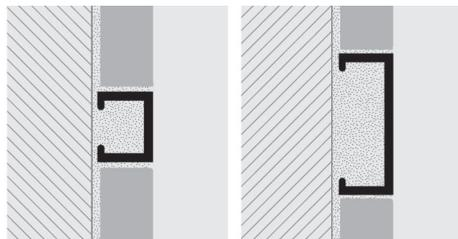
1. Выберите профиль с желаемой отделкой. 2. Нанесите клей на место укладки профиля. 3. Прислоните и подравняйте отрезанный по размеру профиль. 4. Положите плитки или слой смолы так, чтобы верхний край профиля закрывал шов.
