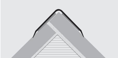
1. Je nach Farbe "PROEDGE AL" auswählen. 2. "PROEDGE AL" auf gewünschte Länge schneiden. 3. Säubern Sie die Auflagefläche von Ölen, Fetten und Schmutzigkeit. 4. Wenn die Auflagefläche trocken ist, die Silikonfolie (Version mit Klebestreifen) entfernen, die Trockenheit des Profils prüfen, das Profil drücken ohne einschlagen/Silikon auf die saubere und trockene Auflagefläche auftragen (Version ohne Klebestreifen), das Profil drücken ohne einschlagen.
