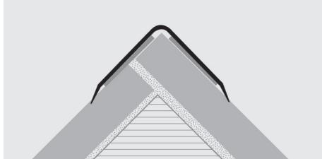
1. Choisir le profilé nécessaire pour couvrir l'angle du revêtement mural/sol. 2. Nettoyer la surface d'appui et s'assurer qu'elle ne soit ni graisse ni humide. Une température supérieure à 15° est conseillée pour l'application. 3. Enlever le film de protection et/ou thermo packed puis le papier de l'adhésif avant de poser délicatement le profilé, sans marteler, en pressant de manière uniforme.
