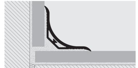
1. Je nach Farbe "PROSEAL 50" auswählen. 2. "PROSEAL 50" auf gewünschte Länge schneiden. 3. Säubern Sie die Auflagefläche von Ölen, Fetten und Schmutzigkeit. 4. Wenn die Auflagefläche trocken ist, die Silikonfolie (Version mit Klebestreifen) entfernen, die Trockenheit des Profils prüfen, das Profil drücken ohne einschlagen/Silikon auf die saubere und trockene Auflagefläche auftragen (Version ohne Klebestreifen), das Profil drücken ohne einschlagen.
