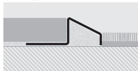
**PROCARPET OTT** è un profilo in ottone che consente di raccordare in modo continuo e senza gradini una pavimentazione ad una moquette e di proteggere i bordi del pavimento, munito di aletta traforata che ne garantisce l'aggancio sotto la piastrella. **PROCARPET OTT** in ottone naturale e lucido è indicato per qualsiasi ambiente ove è richiesta una buona resistenza alle sollecitazioni meccaniche e chimiche.
