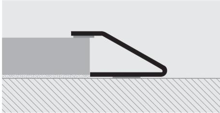
1. Выберите подходящий профиль и отрежьте его по необходимой длине. 2. Прочистите, промойте, обезжирьте твердую поверхность тщательно. 3. Удалите защитную пленку с клеящего средства. 4. Положите профиль правильно, применяя равномерное давление по всей поверхности, не используя молоток.
