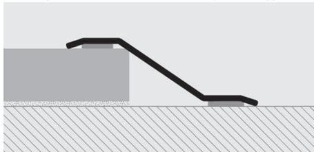
1. Выберите подходящий профиль и отрежьте его по необходимой длине. 2. Прочистите, промойте, обезжирьте твердую поверхность тщательно. 3. Удалите защитную пленку с клеящего средства. 4. Положите профиль правильно, применяя равномерное давление по всей поверхности, не используя молоток.
