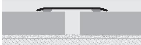
1. Elegir PROPLATE de el ancho y material requerido especificando si tiene que ser con agujeros o con adhesivo. 2. Cortar el perfil a la medida necesaria.
