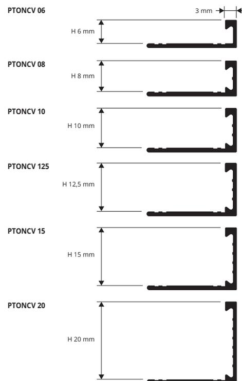
**PROTERMINAL CURVE** es una línea de perfiles curvables/perfilables con un especial troquelado que permite la realización sencilla de formas geométricas, creando diseños decorativos a voluntad y en función de las exigencias técnicas y estéticas con una separación de 3 mm. Se fabrica en aluminio natural en varias alturas (6, 8, 10, 12,5, 15 y 20 mm) en unidades de 2,7 M.
