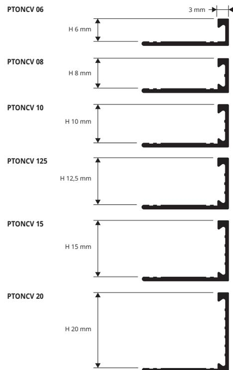
**PROTERMINAL CURVE** - серия сгибаемых/трафаретных окантовочных и разделительных профилей. Характеризуются специальной деформируемой штамповкой, позволяющей легко реализовывать необычные геометрические формы, создавая декоративные рисунки по вкусу в соответствии с техническими и эстетическими потребностями с разделением 3 мм. Натуральная алюминий, высота 6-8-10-12.5-15 и 20 мм, производится в рейках 2.7 м.
