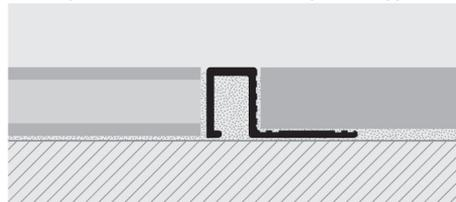
1. Выбрать PROFINAL CURVE с необходимой высотой и материалом. 2. Порезать профиль до необходимой длины, учитывая общую длину. 3. Согнуть профиль механически с помощью PROCURVE MACHINE. 4. В случае необходимости зафиксировать винтами и якорями винта или просто вставить перфорированную основу под пол, уложенную тем же клеящим средством.
