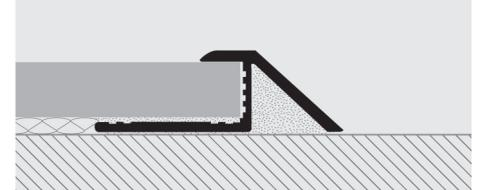
1. Wählen Sie "PROSLIDER CURVE" in der gewünschten Höhe und im gewünschten Material. 2. Schneiden Sie das Profil auf die erforderliche Länge zu und berücksichtigen Sie dabei die Entwicklung. 3. Biegen Sie das Profil mechanisch mit der PROCURVE MACCHINE. 4. Bei Bedarf befestigen Sie das Profil mit Schrauben und Dübeln, wenn es für schwimmende Laminat-/Melaminholzböden zum Einsatz kommt oder setzen Sie einfach die ausgestanzte Schiene unter den mit dem selben Kleber verlegten Fußbodenbelag
