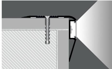
1. "PROSTAIR LED" gemäß dem LED-Typ und dem Flachkabel aus Polycarbonat auswählen.
