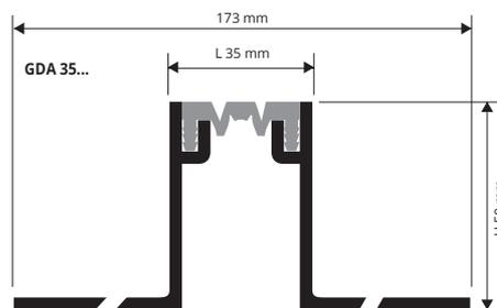
1. "GDA 25 - 35" gemäß der Farbe auswählen. 2. Die gelochten Seitenschenkel des Profils mit Dübeln in einem Abstand von ca. 30 cm an der Struktur befestigen. 3. Den Estrich herstellen und die Fliesen verlegen, dabei eine Fuge von circa 1 mm zwischen Profil und Fliese freilassen. Nach dem Verlegen muss die Fuge immer um 0,5 mm unter der Bodenoberfläche positioniert sein. 4. Die Fugen zwischen Profil und Fliesen vollständig mit Kit ausfüllen, damit kein Wasser in die Hohlräume eindringen kann.
