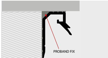
1. Scegliere "PROTERRACE UNDER EDGE C" in funzione del colore desiderato; 2. Tagliare a misura "PROTERRACE UNDER EDGE C"; 3. Incollare il profilo alla struttura con PROBAND FIX e fissandolo con delle viti avendo cura di lasciare 2 mm tra due barre adiacenti; 4. Applicare le giunzioni fissandole con PROBAND FIX.
