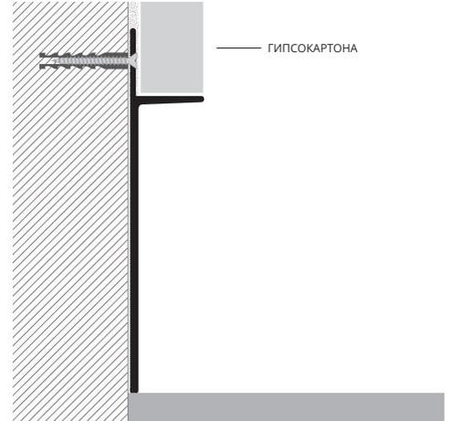
1. Закрепите PROSKIRTING INS винтами (часть, находящаяся под штукатуркой) и клеем/силиконом (под расположенной на виду стороной) перед расположением гипсокартона, рассчитав высоты и расстояния. 2. Установите гипсокартон, выровняв нижнюю часть на уровне PROSKIRTING INS. 3. Заштукатурьте и выполните окончательную поверхность отделку гипсокартона.
