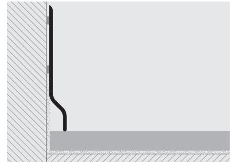
1. Choisir le plinthe de la couleur désirée. 2. La pose doit être effectuée en utilisant du silicone acrylique à fixation rapide, du mastic, du bostic, adaptés pour coller le PVC sur du mortier, du crépi, des parois équipées, etc. ou fixer avec des vis ou des clous.
