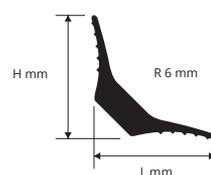
1. "PROCAP S" in der gewünschten Farbe und Höhe auswählen. 2. "PROCAP S" auf die passende Länge zuschneiden. 3. Einen geeigneten Kleber auftragen und das Profil verlegen.
