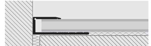
1. Wählen Sie TERMINAL auf der Grundlage der gewünschten Höhe und Oberfläche und befestigen Sie es mit Schrauben und Dübeln oder mit Kleber/Silikon. Setzen Sie das Profil an die uLFaufende Wand, z.B. Mauer, Glas usw. an. 2. Den Laminat-/Melamin-/Holzboden fluchten und sicherstellen, dass der Raum für die richtige Ausdehnung zwischen dem Boden und dem Profil gelassen wird, das wäre ca. 3/10 mm auf einer Seite.
