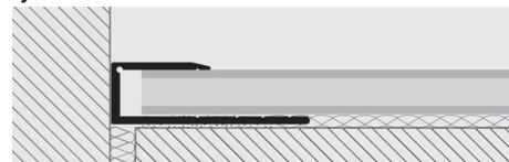
1. Elegir el perfil "TERMINAL" en función de la altura y acabado requerido y fijar con tacos y tornillos o con adhesivo/silicona; acostar el perfil a la pared perimetral. 2. Alinear el pavimento de laminado /madera dejando el espacio para la justa dilatación (3/10 mm por un lado).
