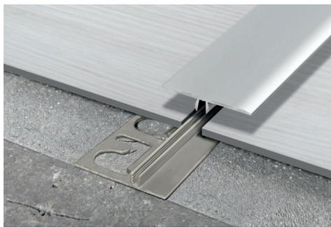
**TOP EN ALUMINIO** 6 acabados alu. anodiz. (3 solo bajo pedido) + **BASE (PVC rígido) thermo empaquetado** - Unid. de 2,7 M de largo - Paq. de 20 UDS - 54 M
