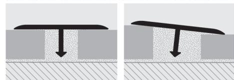
1. Wählen Sie PROCOVER in der der Fuge der zu verbindenden Fußbodenbeläge entsprechenden Breite und berücksichtigen Sie dabei eine seitliche Auflage von 2/3 mm. 2. Füllen Sie die Fuge mit Einkomponentensilikon oder mit dem für des Verlegen des Fußbodenbelags verwendeten Kleber. 3. Tauchen Sie das Profil in den Kleber und achten Sie dabei darauf, dass es mit beiden Seiten auf den zu verbindenden Belägen aufliegt
