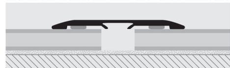
1. Wählen Sie SOL 40 selbstklebend im gewünschten Dekor. 2. Schneiden Sie das Profil auf die erforderliche Länge zu, säubern, entfetten und trocknen Sie die Fläche und stellen Sie sicher, dass die Aufbringtemperatur mindestens 15° iStk. 3. Ziehen Sie das Schutzpapier vom Klebestreifen ab und verlegen Sie das Profil unter gleichförmigem manuellem Andrücken, ohne das Profil dabei zu bewegen und Eisen-/Stahlhämmer zu verwenden.
