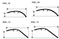
ELOXIERTES ALUMINIUM (6 elox, alu Farben, davon 3 auf Anfrage) Thermoverpackung - Stangenlänge 2,7 Lfm - VE 20 Stk. - 54 Lfm (H 7 - H 9 mm - 108 Lfm)
