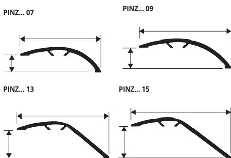
**ALUMINIO ANODIZADO (6 acabados alu. anod., 3 solo bajo pedido) thermo empaquetado** - Unidades de 2,7 M paq. de 20 UDS - 54 M (H 7 - H 9 mm - 108 M)
