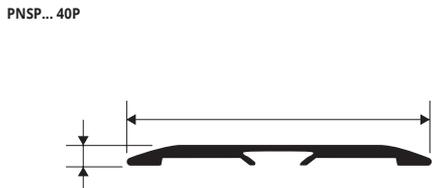
**ALUMINIO ANODIZADO (6 acabados alu. anod., 3 solo bajo pedido) thermo empaquetado** - Unidades de 2,7 M de largo - Paq. de 40 UDS - 108 M
