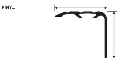
**ALUMINIO ANODIZADO (6 acabados alu. anod., 3 solo bajo pedido) thermo empaquetado** - Unidades de 2,7 M de largo - Paq. de 20 UDS - 54 M
