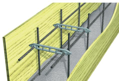
**POLYPROPYLÈNE HD GRIS pour treillis d'un diam. maxi. de 8 mm**
