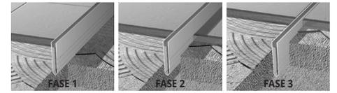
1. "ANSCHLUSSPROFIL FÜR MÖRTELVERLEGUNG" gemäß der Höhe und der gewünschten Farbe auswählen. 2. "ANSCHLUSSPROFIL FÜR MÖRTELVERLEGUNG" auf die gewünschte Länge zuschneiden. 3. Den Estrich mit der Kelle entlang des Fußbodenrandes schneiden. 4. Die Fuge im frischen Estrich positionieren, dabei darauf achten, dass sie mit der Oberfläche des Fußbodens ausgerichtet wird. 5. Den Estrich und den Fußboden verlegen.
