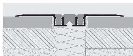
1. Scegliere "PROEXPAN 115-130-190-210" in funzione dei movimenti previsti e del colore desiderato. 2. Tagliare "PROEXPAN 115-130-190-210" alla lunghezza desiderata. 3. Fissare le alette in alluminio alla pavimentazione con resina epossidica bicomponente
