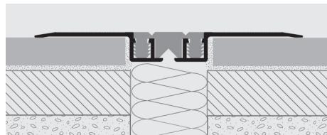
Закрепите боковые выступы/фланцы из алюминия с. **1.** Болты и винтовые анкерные болты по интервалам в 20 см по обеим сторонам всего шва. **2.** Две упаковки клеящего средства из эпоксидной смолы или с сильным быстро закрепляющимся силиконом.
