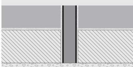
1. "ANSCHLUSSPROFIL FÜR MÖRTELVERLEGUNG" gemäß der Höhe, des Materials und der gewünschten Farbe auswählen. 2. "ANSCHLUSSPROFIL FÜR MÖRTELVERLEGUNG" auf die gewünschte Länge zuschneiden. 3. Den Estrich mit der Kelle entlang des Fußbodenrandes schneiden. 4. Die Fuge im frischen Estrich positionieren, dabei darauf achten, dass sie mit der Oberfläche des Fußbodens ausgerichtet wird. 5. Den Estrich und den Fußboden verlegen.
