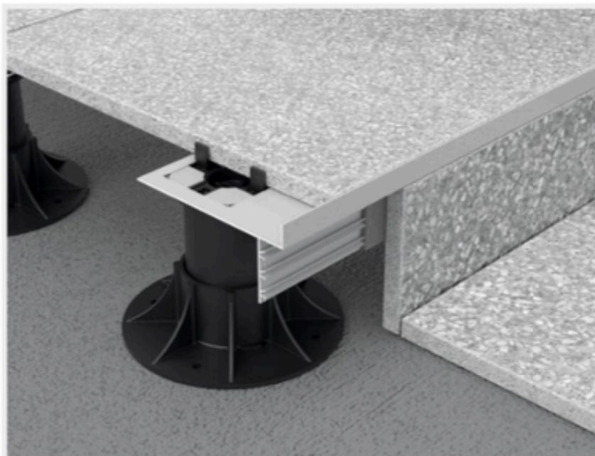
Prosupport System di Progress Profiles ([www.progressprofiles.com](http://www.progressprofiles.com)) è un sistema di supporti per pavimentazioni sopraelevate modulari e regolabili (da 35 a 200 mm) in polipropilene. La testa piana autolivellante può avere un'inclinazione dello 0-5%. Prezzo su preventivo.
