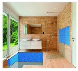
La membrana, desolidarizzante e impermeabilizzante, con alta resistenza allo strappo, è realizzata in polietilene ed è provvista di un tessuto non tessuto in polipropilene termosaldato nella parte inferiore, su cui viene montato il cavo elettrico provvisto di diverse resistenze in parallelo che, se danneggiato localmente, non interrompe il funzionamento dell'intero sistema.
