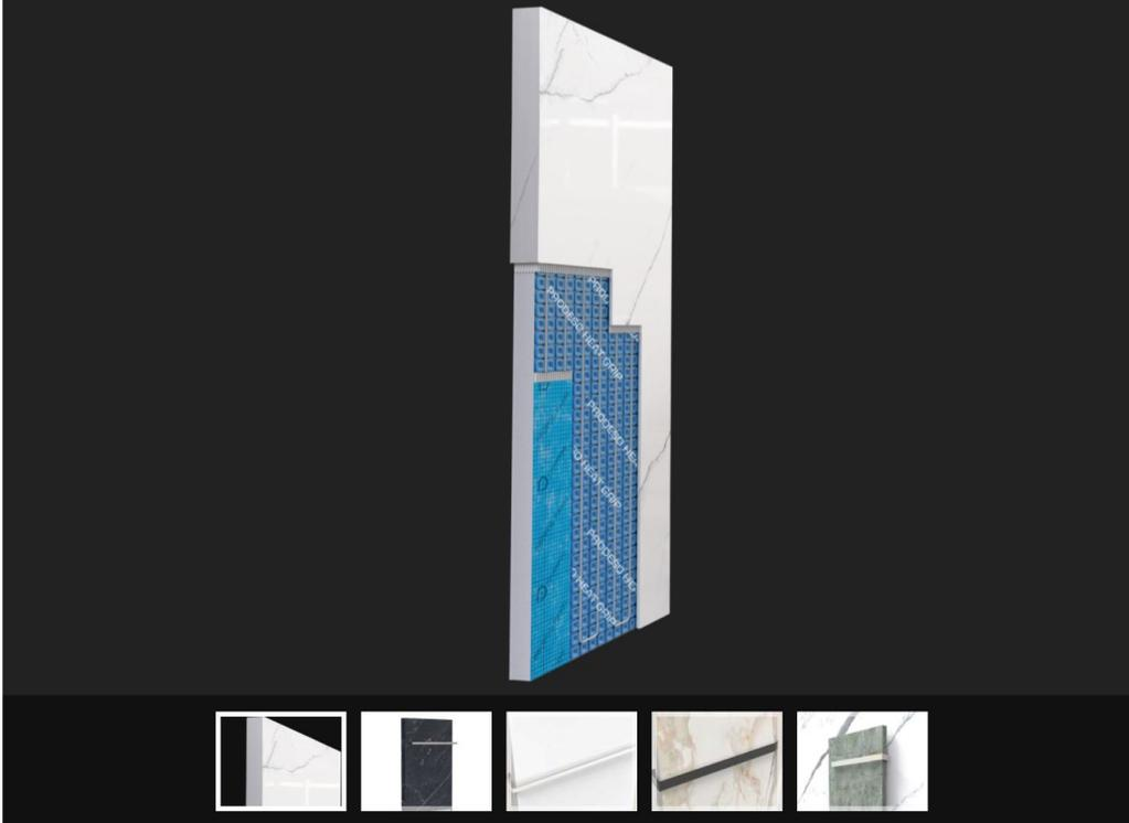
Il pannello portante **Profoil Panel**, in polistirene estruso ad alta densità ( $33 \text{ kg/m}^3$ ), ha una elevata capacità isolante ed è rivestito su entrambi i lati da una membrana impermeabile all'acqua e al vapore che conferisce al pannello una elevata rigidità.
