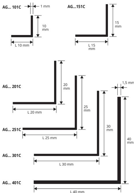
ALUMINIO ANODIZADO ORO Y PLATA termo empaquetado
