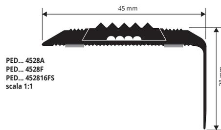
ALL. ANODIZZATO con adesivo CON INSERTO thermo packed
