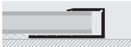
1. Choisir le **TERMINAL CURVE** de la hauteur et du matériel désirés. 2. Couper le profilé à la longueur nécessaire en calculant le développement. 3. Courber le profilé mécaniquement avec la **PROCURVE MACHINE**. 4. Le fixer si nécessaire à l'aide de vis et de chevilles s'il est utilisé pour des revêtements de sol flottants en bois stratifié mélaminé ou introduire simplement la base coupée sous le revêtement posé avec la même colle.
