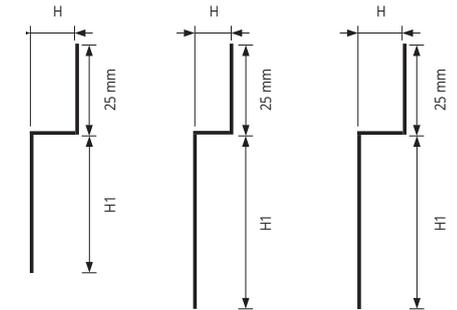
**PROSHOWER PROFILE WALL** es un perfil en acero inox AISI 304 / 1.4301 - V2A satinado apto a cubrir y decorar la parte visible de la pared de al lado de duchas a nivel del suelo con una inclinación de 2%.
