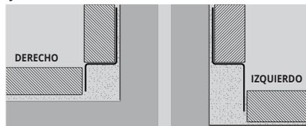
1. Elegir "PROSHOWER PROFILE WALL" en la longitud requerida y espesor de la baldosa.
