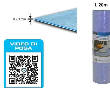
PROECOFON è un rotolo di polietilene a cella chiusa usato nel perimetro tra muro e massetto, e in coincidenza di giunti di dilatazione. È consigliabile usarlo in ogni lavoro di posa per garantire la durata del pavimento.
