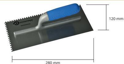
**FRATTONE** in lamina di acciaio 5x7, supporto in alluminio brillantato con fissaggio elettrosaldato. Impugnatura in gomma fissata con sistema anti-rotazione. Particolarmente indicato per la posa dei sistemi impermeabilizzanti e desolarizzanti Prodeso® e Prodeso® Heat & Prodeso® Heat grip.
