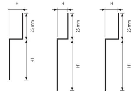
**PROSHOWER PROFILE WALL** Это профиль в сатинированная нержавеющая сталь AISI 304/1.4301-v2a. идеально подходит для покрытия и украшения поддона для душа, когда на уровне пола. 1,5% склонны облегчить укладку плитки без резки.
