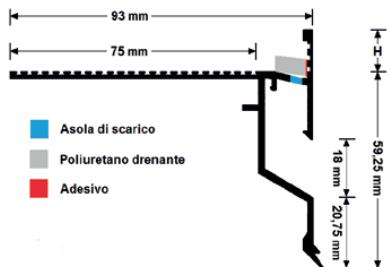
Profilo perimetrale in alluminio verniciato a polvere opportunamente studiato per proteggere i bordi delle piastrelle posate su terrazzi e balconi e per garantire un corretto deflusso delle acque. Il profilo è munito di un distanziatore che garantisce il suo corretto posizionamento e di una striscia adesiva in poliuretano a cellula aperta che impedisce al silicone di ostruire i fori di drenaggio.
