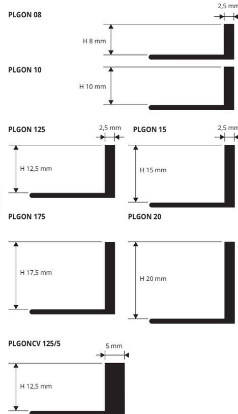
**PROLEVIGAL** è un profilo di separazione in alluminio a forma di "L", da posare tra due diverse pavimentazioni o da utilizzare come profilo decorativo all'interno di rivestimenti. Il profilo, munito di aletta traforata che ne garantisce l'aggancio sotto la pavimentazione e di pareti verticali perfettamente lisce è levigabile in opera. **PROLEVIGAL** in alluminio è indicato per qualsiasi ambiente ove è richiesta una buona resistenza alle sollecitazioni meccaniche e chimiche
