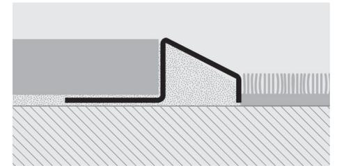
**PROCARPET OTT** è un profilo in ottone che consente di raccordare in modo continuo e senza gradini una pavimentazione ad una moquette e di proteggere i bordi del pavimento, munito di aletta traforata che ne garantisce l'aggancio sotto la piastrella. **PROCARPET OTT** in ottone naturale e lucido è indicato per qualsiasi ambiente ove è richiesta una buona resistenza alle sollecitazioni meccaniche e chimiche.
