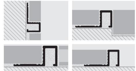
1. Je nach Höhe der Fliese PROFINAL auswählen. 2. Das zugeschnittene "PROFINAL" anbringen, anpassen und Fliesenkleber in Anwendungsbereich auftragen. 3. Der Schenkel von "PROFINAL" auf die Klebemasse drücken. 4. Die Fliesen sorgsam auf gleicher Höhe mit der Profilkante mit einer Fuge von etwa 2 mm anbringen. Sofort die Reste von Kleber von der Oberfläche des Profils entfernen. 5. Der Raum zwischen Profil und Fliesen großzügig mit Fugenkleber gegen Wassereinlagerungen absichern.
