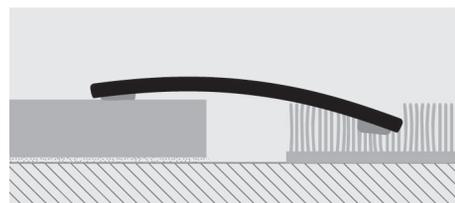
1. Je nach Breite "PROSOL 18-30-35-40" auswählen. 2. "PROSOL 18-30-35-40" auf gewünschte Länge schneiden. 3. Die Auflagefläche von Ölen, Fetten und Schmutzigkeit reinigen. 4. Wenn die Auflagefläche trocken ist, die Silikonfolie entfernen, die Trockenheit prüfen, das Profil drücken ohne einschlagen.
