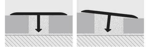
1. Choisir le PROCOVER d'une largeur correspondant au joint entre les deux revêtements à unir en tenant compte d'un appui latéral de 2/3 mm. 2. Remplir le joint de silicone ou de la colle utilisée pour la pose du revêtement. 3. Enfoncer le profilé dans la colle en s'assurant qu'il soit bien appuyé des deux côtés sur les revêtements à unir.
