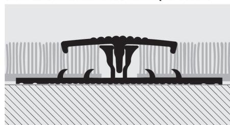
1. Couper le profilé à la longueur nécessaire. 2. Fixer la base percée au sol à l'aide de vis/clous ou d'adhésif double face/scotch. 3. Poser la moquette en la collant ou en la tendant. 4. A l'aide d'une planchette de bois, marteler le top uniformément afin de l'introduire, par déclin, dans la base en bloquant les deux côtés de la moquette.
