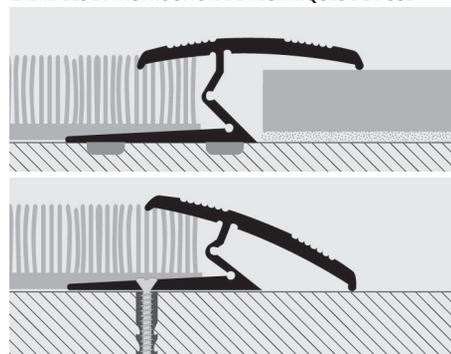
1. Couper le profilé à la longueur nécessaire. 2. Fixer le **PROMOQUETTE GIN** au sol à l'aide de vis/clous ou d'adhésif double face/scotch. 3. Poser le revêtement désiré en introduisant la moquette, le pvc, le linoléum, la céramique ou le bois sous la partie supérieure courbée du profilé. 4. Ecraser le profilé en pressant de manière uniforme de manière à ce que le profilé couvre des deux côtés, au ras du revêtement.
