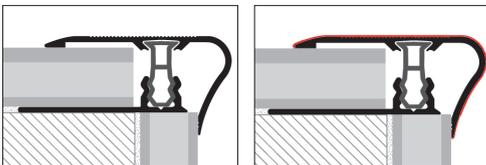
1. Befestigen Sie die Schiene genau über der Stoßstufe der Treppe.
