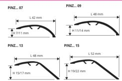
ALUMINIO ANODIZADO (6 acabados alu. anod., 3 solo bajo pedido) thermo empaquetado - Unidades de 2,7 M
